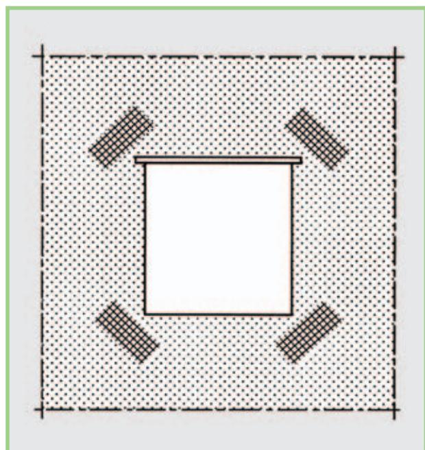
Fig. 23: Armatura diagonale supplementare sugli spigoli della finestra.
