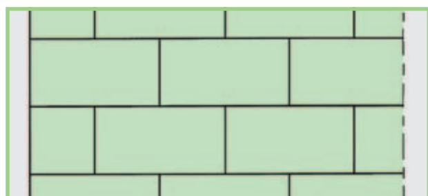
Fig. 9: Schema per la posa di lastre di Styrodur C allineate a giunti sfalsati. Si devono evitare giunti incrociati.
