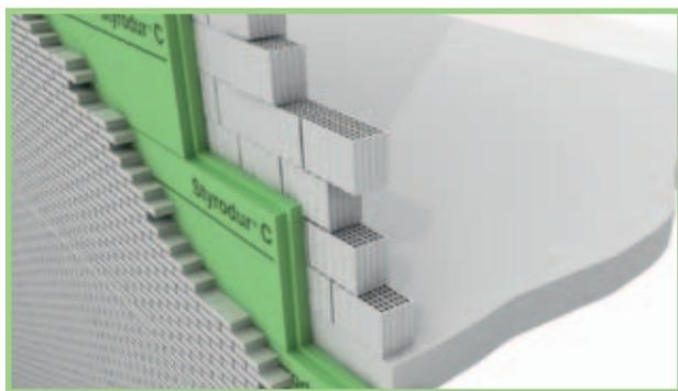
Le strutture murali doppie rappresentano il metodo costruttivo tradizionale in molte regioni dell'Europa. Il ridotto assorbimento d'acqua, le buone proprietà termoisolanti e la durata di Styrodur® C consentono la posa tra le due pareti anche senza strato d'aria.
