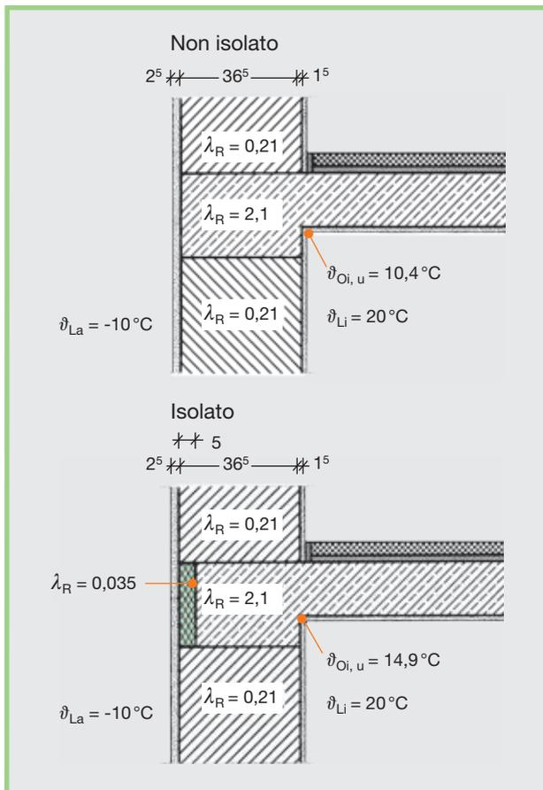
**Fig. 10:** Supporto del solaio con indicazione della temperatura superficiale interna senza e con isolamento dei ponti termici con Styrodur® 2800 C, spessore 5 cm.
