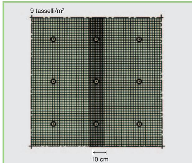
**Fig. 27:** Armatura su tutta la superficie con una rete metallica come incannicciatura (9 tasselli per m<sup>2</sup>).
