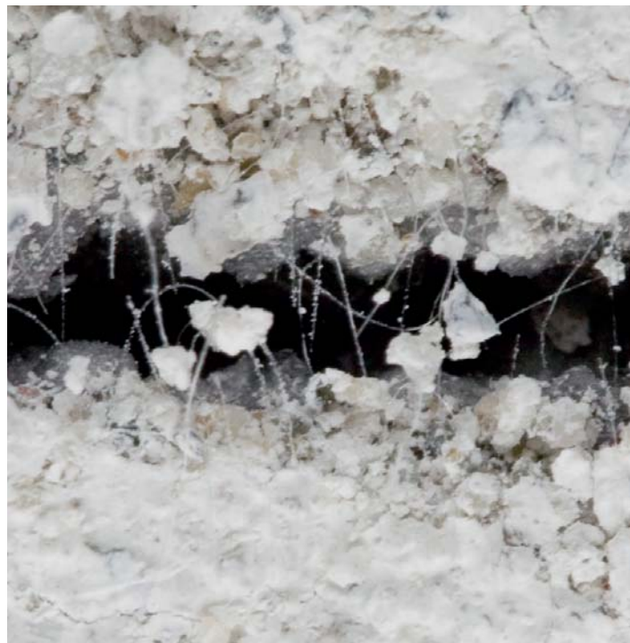
L'aggiunta di fibre all'impasto crea una microreticolatura che contrasta le cavillature superficiali. Nell'immagine l'intonaco è stato volutamente strappato per evidenziare la presenza delle fibre in polipropilene.
